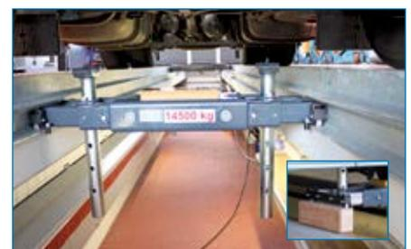
Ausgezogen mit Absetzträger und Zweipunktaufnahme
