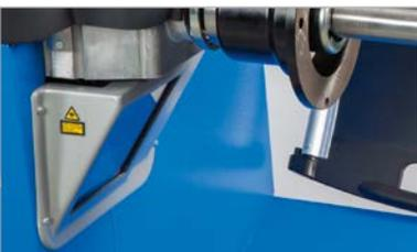
Der Felgenscanner erfasst automatisch Felgendurchmesser und Abstand sowie die Anzahl und Position der Speichen. Dann wählt er automatisch das Auswuchtprogramm, Gewichtetyp und -position. Zusammen mit der automatischen Felgenbreitenerfassung über Smart Sonar verbindet das hohe Präzision mit hoher Produktivität.
