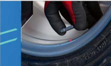
Schnelle, punktgenaue und einfache Positionierung von Klebengewichten durch einen Laserpunkt. Da die Gewichte position unten in der Felge angezeigt wird, kann der Bediener die Gewichte mühelos, schnell, genau und fehlerfrei anbringen.
