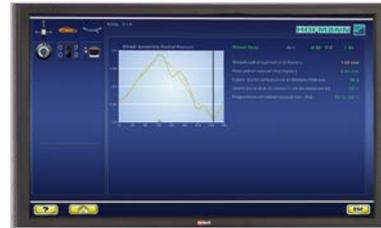
Die Höhengschlagdiagnose erfolgt während der Unwuchtmessung, bedeutet daher keinen zusätzlichen Zeitaufwand. Hoher Höhengschlag wird automatisch bei der Felgendiagnose erfasst und geometrisches Matchen zur Lösung der durch Formfehler bedingten Vibrationsprobleme empfohlen (nur geodyna 8200-2p und 8250-2p).
