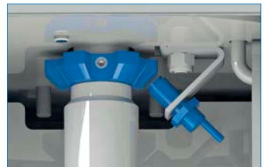
Verschleißfreie und berührungslose Induktivgeber zur Hubhöhenenerkennung (Abb. 3,5 t)
