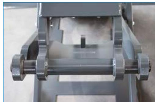
Hohe Seitenstabilität durch stark dimensionierte Scherenarme
