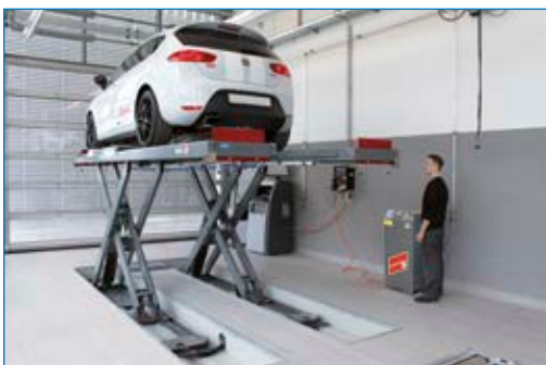
Durch die große Hubhöhe von ca. 2100 mm ideal für den Einbau in ein Streifenfundament. Nutzbare Hubhöhe bei dieser Einbauart min. 1850 mm
