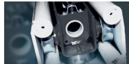
Stabile, geschweißte Säule und rollengelagerter Hubstuhl
