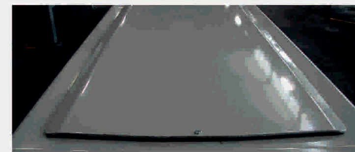
Schiebepplatten mit pneumatischer Verriegelung über den Steuerschrank Sliding plates with pneumatic locking on the control unit
