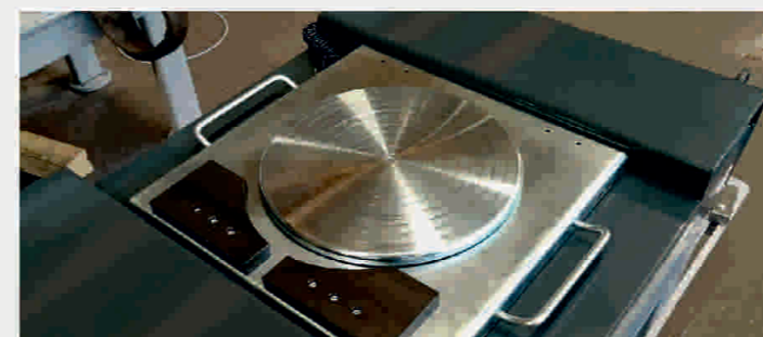
Pneumatische verriegelbare Drehteller über den Steuerschrank Pneumatic lockable turntables on the control unit
