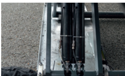
Doppeltes Hydrauliksystem, somit keine Druckluft erforderlich
