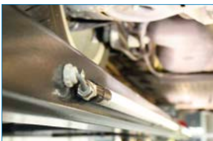
2-/4 fach LED Beleuchtung an der Fahrfläche
