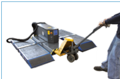
Mit dem Mobilrahmen ist die Hebebühne mit einem herkömmlichen Hubwagen oder Stapler einfach und schnell örtlich versetzbar. Eine Verankerung der Hebebühne am Fußboden ist nicht notwendig, der Montagerahmen ist freitragend und benötigt lediglich einen befestigten Untergrund.
