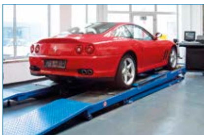
Schrägstellung bei Überflurmontage, hydraulisch oder mechanisch, zur leichteren Auf- und Abfahrt (R-AS 40 CM A)
