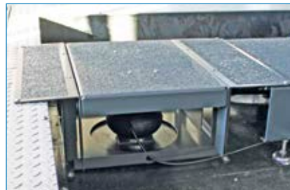
Pneumatischer Hubboden bei definierter Achsliftposition für Streifenfundament
