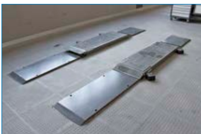
Überfahrampen: Dadurch verringert sich die Überfahrhöhe der bodenauflegend montierten Hebebühne um 40 mm
