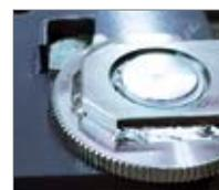
Sicheres und feinfühliges Arretieren der Tragarme durch Rastensystem.
