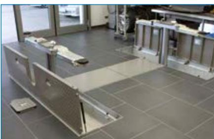
Rahmensystem mit Abdeckplatten, komplett feuerverzinkt
