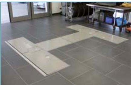
Vollständig abgedeckte Schwenkarmaufnahme mit einer Radlast von 2 t überfahrbar
