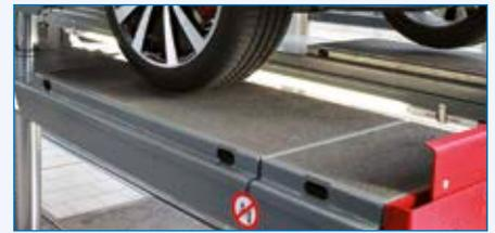
Fahrflächen mit Ausgleichsplatten zum Niveaugleich an den Radfreiheber oder an die Achsvermessung.
