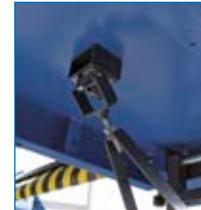
Befestigungssystem und Arretierung der Fahrflächenabstützung.
