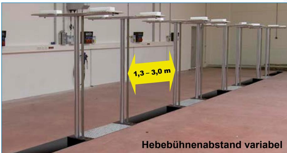
Die Hubeinheiten können innerhalb des „Kanals“ an jede beliebige Position gesetzt werden. Dadurch ist der Hebebühnenabstand variabel wählbar.
