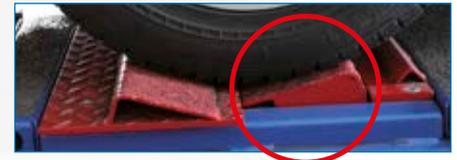
Hintere Prismenhälfte wird automatisch zur Achsprüfung ausgefahren
