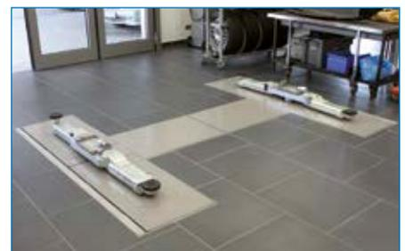
Die Hebebühne kann mit geschlossener Abdeckung als Standard-Hebebühne genutzt werden
