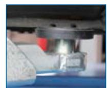
Die Tragteller der Schwenkarmaufnahmen können sehr exakt an den entsprechenden Aufnahmepunkten, unter dem Fahrzeug positioniert werden.
