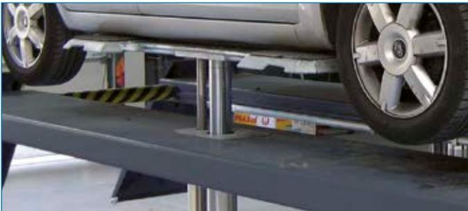
Fahrflächen-Hebebühnen mit Flachträger-Radfreiheber, Schwelleraufnahme Traglast 3,5 t
