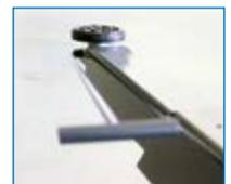
Einstellhilfe zum Punktgenauen einstellen des Schwenkarmes zum Fahrzeugaufnahme-punkt.
