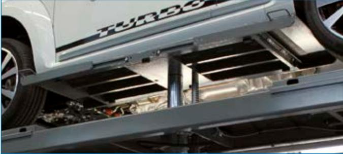
Fahrflächen-Hebebühnen mit Plattform-Radfreiheber, Schwelleraufnahme Traglast 3,5 t
