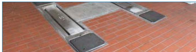
Für leichtes Überfahren der Flachträgeraufnahme. Mithilfe des Einbaurahmens D-ER (VZ 972420) sowie den geraden Auszügen (VZ 972519) kann die Flachträger-Hebebühne bodeneben eingebaut werden. Dadurch ist ein schnelles Heben und Senken ohne Verstellen der Auszüge gewährleistet.
