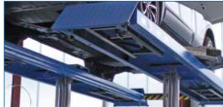
Sicheres und einfaches Aufbewahren der Fahrflächenstützen in der Fahrfläche.
