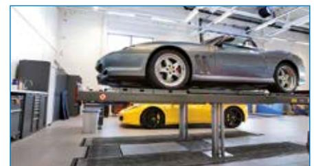
Einbaurahmen für Fahrflächenvarianten mit und ohne Bodenausgleich zum genauen Einpassen der Hebebühne. Durch die vorgefertigten Einfassungsrahmen wird beim Einbau eine hohe Genauigkeit erreicht.
