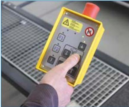
Steuerung mit Kabelfernbedienung
