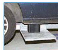
Durch Zusammenschieben der Aufnahmen können die Fahrzeuge an den Schwellern gehoben werden.
