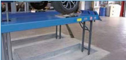
Höhennivellierung bei 1200 mm durch Achsmessstützen. Teleskopierbare Achsmessstützen 1375 – 1700 mm (optional).
