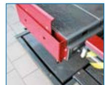
Der Bodenausgleich schafft ein einheitliches Werkstattboden-Niveau.
