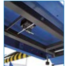
Befestigungssystem und Arretierung der Fahrflächenabstützung.
