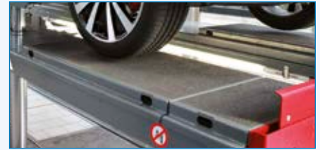
Fahrflächen mit Ausgleichsplatten zum Niveaugleich an den Radfreibeber oder an die Achsvermessung.
