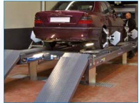
Hohe Genauigkeit als Achsmessehebühne.
