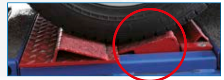
Hintere Prismenhälfte wird automatisch zur Achsprüfung ausgefahren
