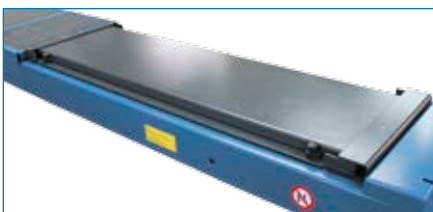
Schiebeplatten mit Querbewegung von 60 mm und Drehbewegung von 5°. Ausführungsängen: 1060 mm, 1465 mm oder 1800 mm (je nach Fahrflächenaufbau)
