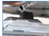
Pyramidenklötz für punktgenaue Aufnahme und hoher Bewegungsfreiheit unter dem Fahrzeug VZ 975634
