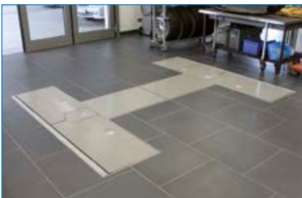
Vollständig abgedeckte Schwenkarmaufnahme mit einer Radlast von 2 t überfahrbar
