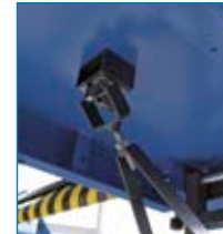
Befestigungssystem und Arretierung der Fahrflächenabstützung.
