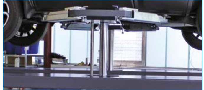
Fahrflächen-Hebebühnen mit Schwenkarm-Radfreiheber, Rahmen- und Schwelleraufnahme Traglast 3,2 t
