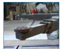
Unterschwenkhöhe am Aufnahmeteller von 123 mm
