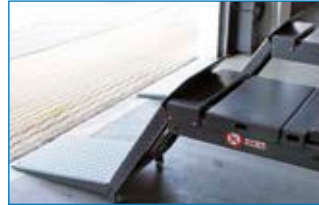
Klapp-Auffahrrampe bei hohen Fahrflächen oder geringem Auffahrwinkel
