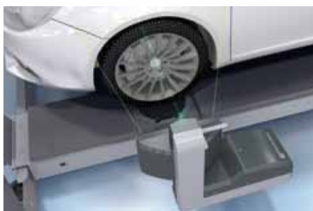
Digitale Bildverarbeitung mit hoher Bildrate generiert ein 3D-Modell des Rades.
