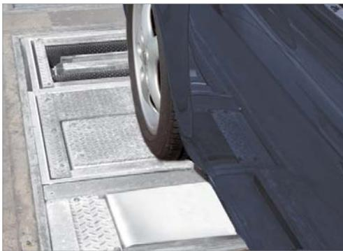
Der Verschleiß der Stoßdämpfer ist ein schleichender Prozess, den der Kunde meist nicht bemerkt. In weniger als einer Minute kann der Fahrwerktester Ursachen für gefährliches Kurvenverhalten, unregelmäßig abgenutzte Reifen, flatterndes Lenkrad, mangelnde Fahrstabilität bei Seitenwind und schlechtes Bremsverhalten ermitteln.
