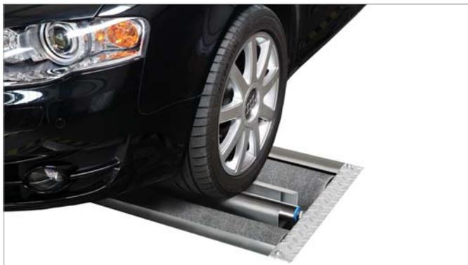
Durch das Anheben der Hebeschwelle kann das Fahrzeug ebenerdig in den Prüfstand ein- und ausgefahren werden. Bei Fahrzeugen mit Sportfahrwerk, geringer Bodenfreiheit und kleinem Raddurchmesser besteht keine Gefahr von Beschädigung am Unterboden.
